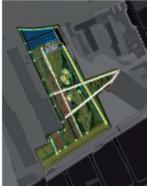
Paris'de bulunan Parc des Batignolles'in (4,5 hektar) aydınlatma konsepti toplam 9 KW elektrik tüketimine sahip. Sadece dört ana yol sürekli aydınlatılıyor (Peyzaj mimarı Jacqueline Osty; Mimar Francois Grether, Lichtdesign Concepto)
