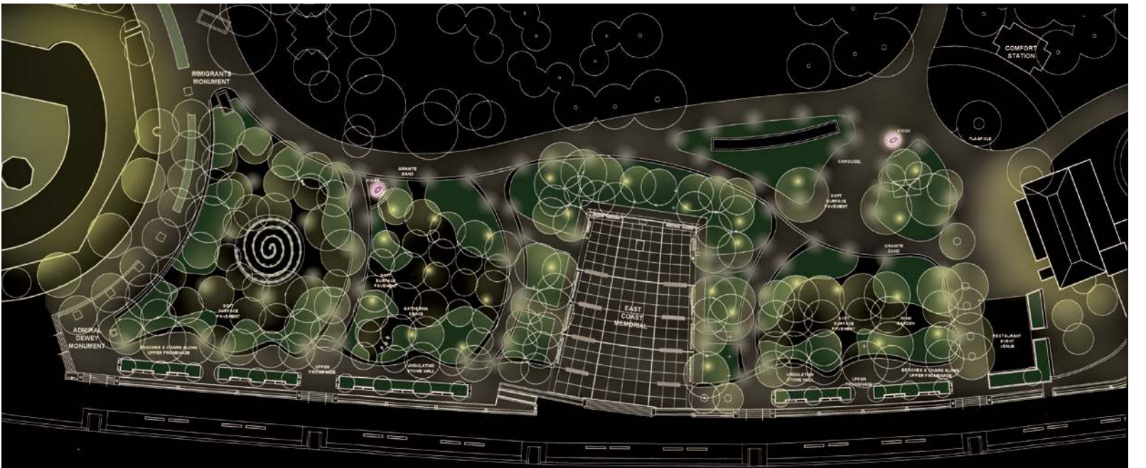
Plan üzerinde park alanı yerleşimleri ve her bir aydınlatma elemanı gösteriliyor. Açık renkli ısıt noktaları Poller türü lambaların pozisyonunu gösteriyor.
