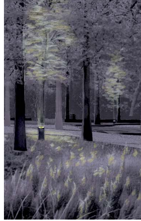
Poller türü lambalar ile yaratılan Uplight efektlerinin sematik gösterimi. Yukarı doğru yönlendirilen ışık, ağaçların yapraklarını çerçevesiyor.
