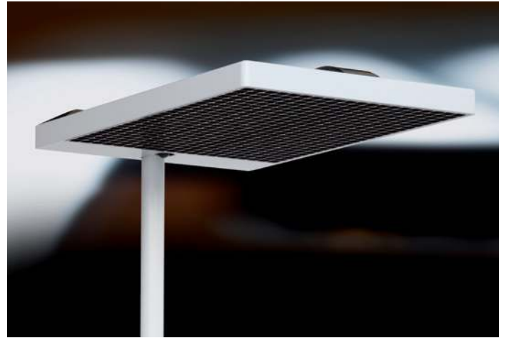
Yeni ofis lambası XT-A LED / OSA, parlak beyaz LED'lerin (3500K, CRI >85) göz kamaştırmasını önlemek için OSA raster kullanılıyor. Lambalar dim edilebiliyor; ayrıca sensörlü bir kumandaya sahip. 0,2 Watt'a indirilmiş Stand-by tüketimi ile birlikte lamba en zorlu çevre şartlarını sağlıyor.
