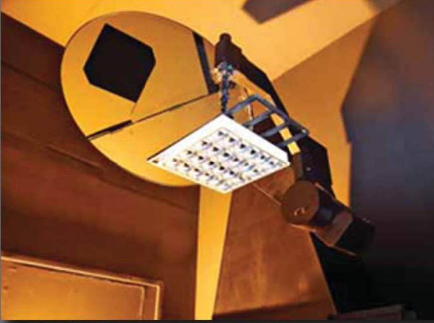
Döner Aynalı Gonyofotometre
