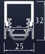
6803120 U PMMA Sıva üstü profil 20W/m 1400lm/m 40LED/m 5630 LED
