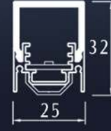
6803120 U PMMA Sıva üstü profil 20W/m 1400lm/m 40LED/m 5630 LED
