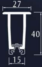
650116 U PMMA Sıva altı profil 16W/m 1200lm/m 160LED/m 3014 LED
