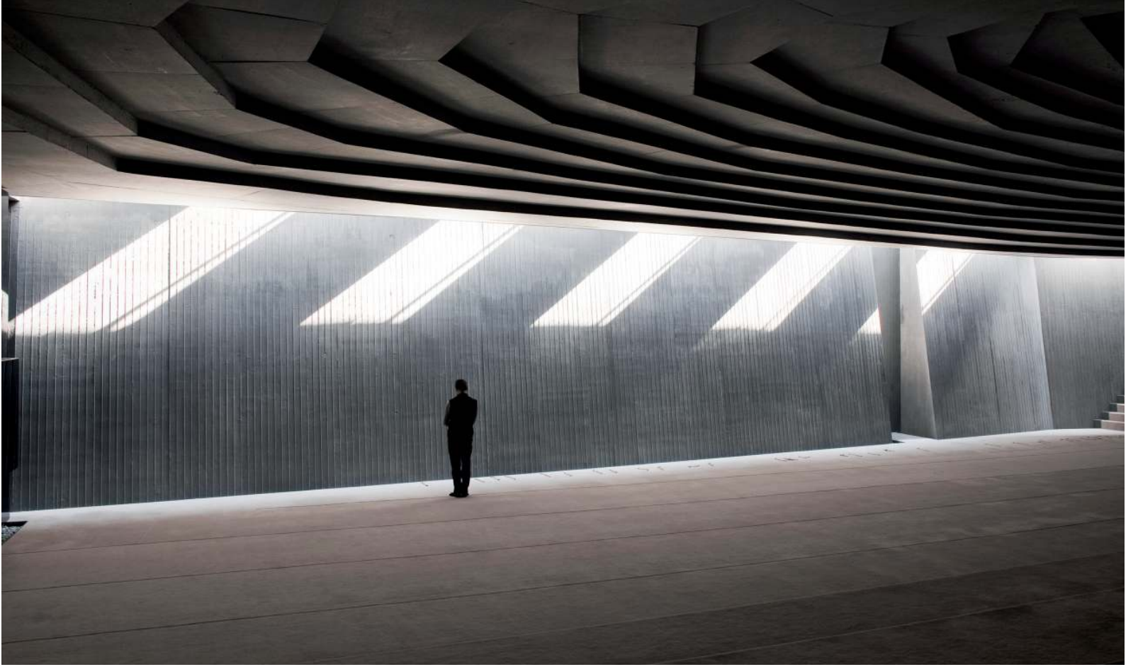
Gün ışığı sensörleri ile duvarda her zaman aynı miktarda ısı olacak şekilde yapay aydınlatma ve gün ışığı birlikte kullanıldı.
