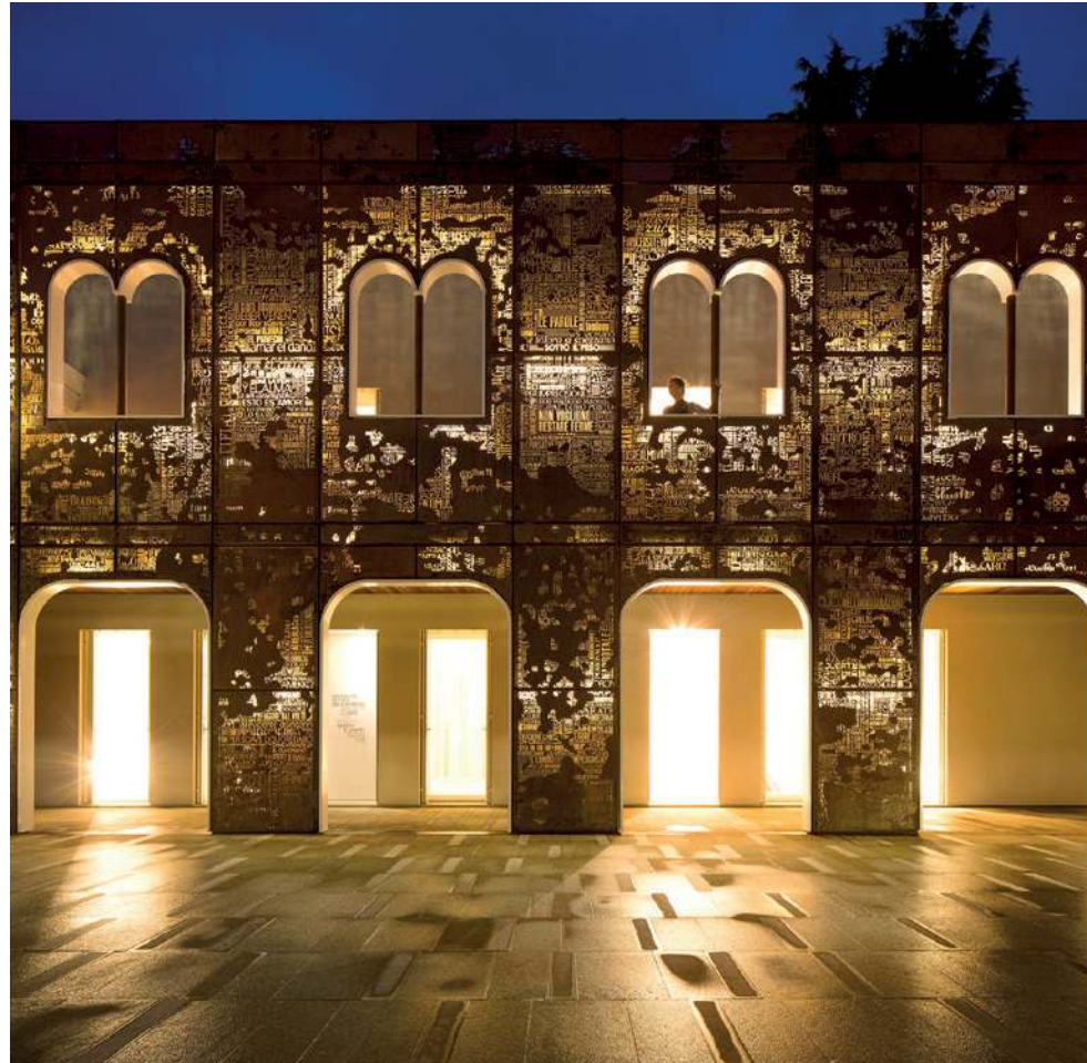
Kemerlerin arasındaki sütunlara entegre edilen, duvara monte edilmiş LED armatürler, mimari öğeleri hafifçe öne çıkartıyor.
