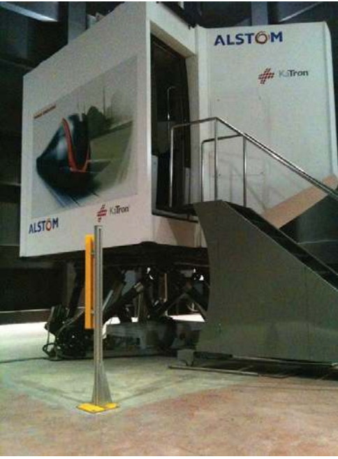
Resim 5: T1 Bağcılar Kabatas hattında kullanılan tren kabininin 1:1 ölçekli, 6 serbestlik dereceli simulator modeli.
