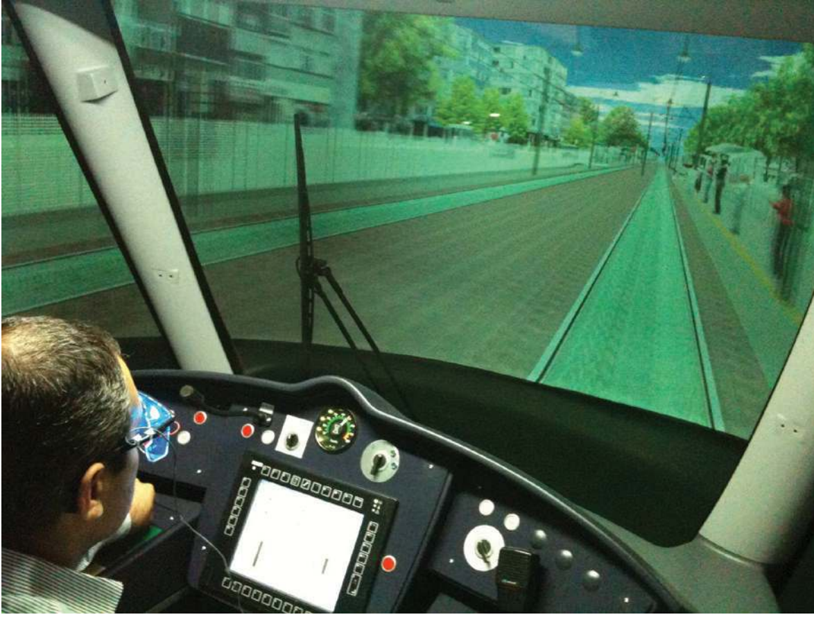
Resim 3: T1 Bağcılar Kabatas Hattının ve bu hatta çalışan trenin simule edildiği çalışmada, makinist 470 nm ıslık veren gözlük takılı halde sürüş yaparken.
