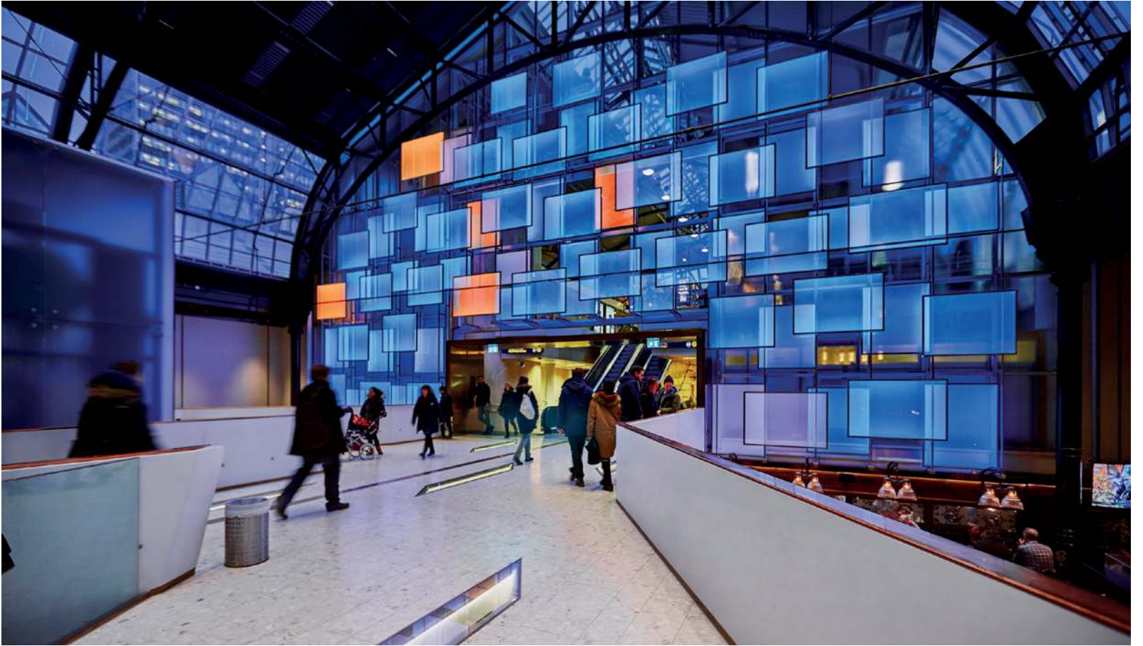
ÅF Lighting tarafından tasarlanan piksel duvarı, kısaca Ø olarak adlandırılan Østbanehallen tren garının çekirdeği. Duvar 71 LED panelden oluşuyor. Panellerin her biri Norveç'in gün batışını veya güneşin batışı ile gece arasındaki mavi saatleri simüle edecek şekilde kontrol edilebiliyor. Binada başka atmosfer ve efektler de yaratılabiliyor.
